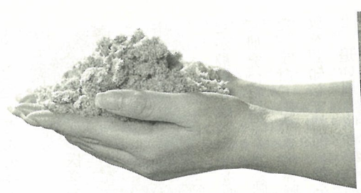
新聞紙をリサイクルしたセルロースファイバー断熱材（CF断熱材）
