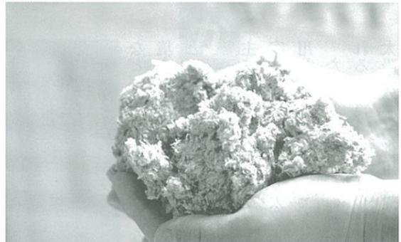
安成工務店の住宅づくりの特長がセルロースファイバー断熱材の採用。グループ会社のデコスが製造・販売しており、「デコスドライ工法」を確立。高性能な断熱材と品質の高い施工により、優れた断熱性能を実現している
