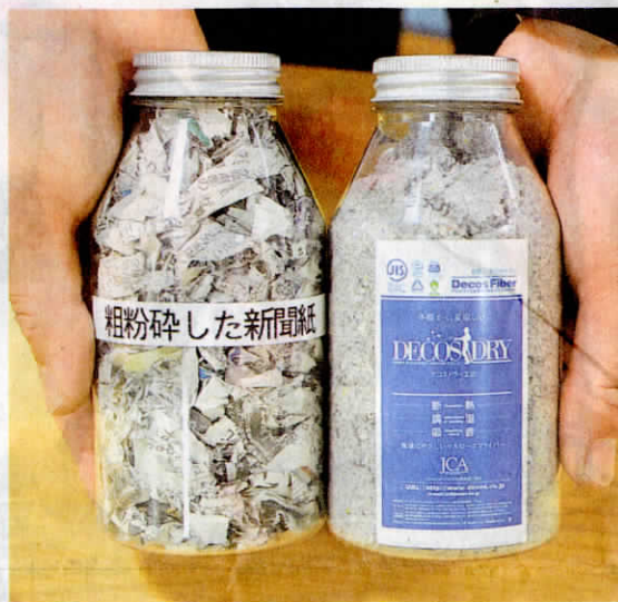
新聞紙を粉碎した原料(左)とセルロースファイバー —埼玉県飯能市のデコス関東工場
