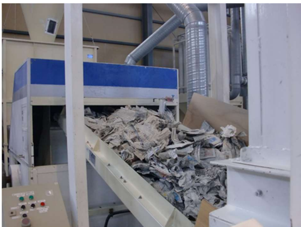
新聞紙をリサイクル、石油系エネルギーを用いず製造する断熱材「デコスファイバー」
