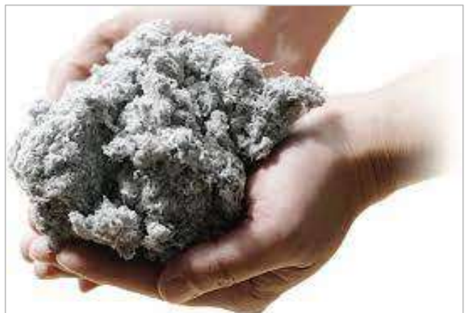
新聞紙をリサイクル、石油系エネルギーを用いず製造する断熱材「デコスファイバー」
