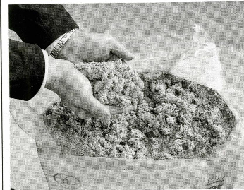
原料の80%に新聞紙を利用したセルロースファイバーの断熱材。これを外壁と内壁の間に吹き込む=埼玉県飯能市
