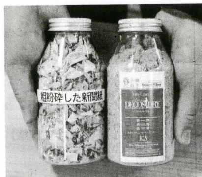
新聞紙を粉砕した原料(左)とセルロースファイバー(右)埼玉県飯能市のデコス関東工場
