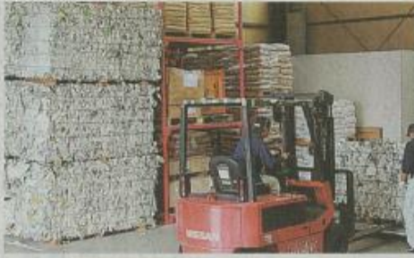
古新聞の固まりが積み重ねられたテコス山口工場。壁に充てんする作業の綿状のセルロースファイバー
