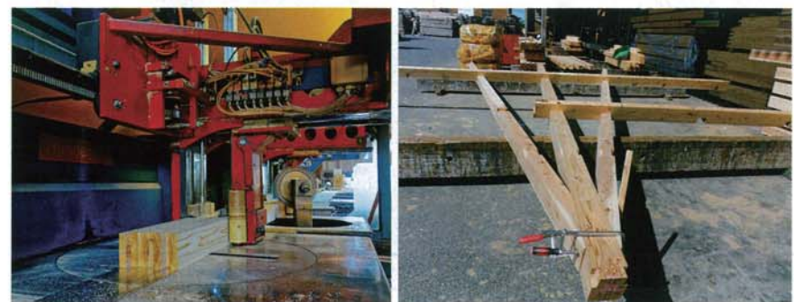
左：フンデガーの3D加工機で木材を加工。 右：多目的ホールの架構の仮組み。
