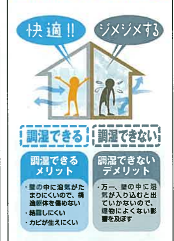
本来の断熱性能はもちろん、調湿性や吸音性など、メリットの多い断熱材 大きな吹抜けがあるなど、オープンな間取りの家でも床・壁・天井などに隙間なく断熱材を吹き込むことで、温度差や湿度差が少ない快適な室内環境を保つことができる
